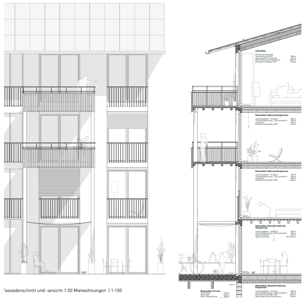
Abbildung 39: Konstruktionsschnitt und Ansicht Wohnung
