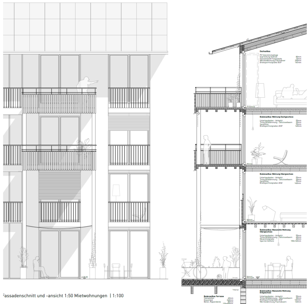
Abbildung 39: Konstruktionsschnitt und Ansicht Wohnung
